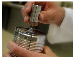
Đo nhiệt độ tâm của sản phẩm thực phẩm đóng hộp
