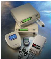
Âm kế điện tử có cảm biến để đo độ ẩm cân bằng (ERH)
